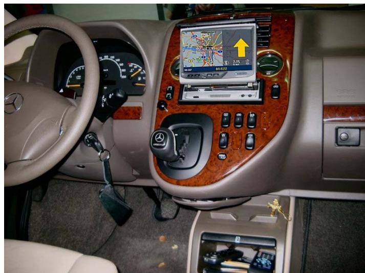
Für die Navigation wurde die Blaupunkt DX – V mit dem dazugehörigen TMC Modul zur dynamischen Wegstreckenüberwachung gewählt. Diese Lösung berücksichtigt auch die Veränderungen auf der Fahrstrecke ( z.B. Stau ) während der Zielführung.
