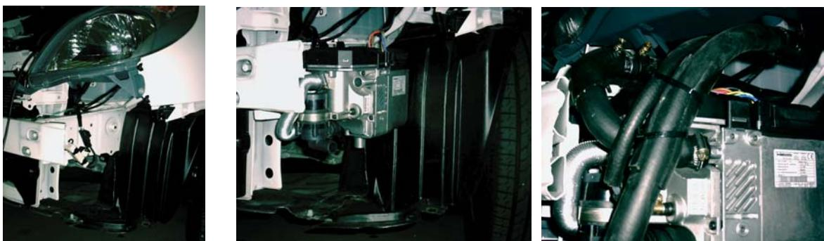
wurde noch die Kraftstoffentnahme und die Elektroinstallation nach den Webasto Einbauplänen durchgeführt.
