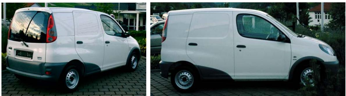
Die leichteste Aufgabe stellte die Heckscheibe dar. Sie wurde mit einer TÜV zugelassenen Scheibenfolie abgedunkelt.
