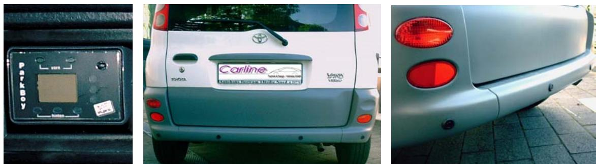
Der Einbau des Audiosystems gestaltete sich schwierig, da es weder von Toyota, noch im Zubehörbereich eine Radioeinbaubleide gab. Sie musste von uns manuell angefertigt werden.
