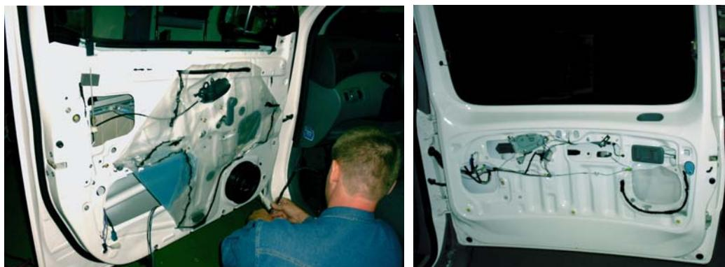
Da der Kunde für die Funkfernbedienung keine zusätzliche Fernbedienung benutzen wollte, sollte ein Schlüsselkopfsender an den Originalschlüssel angepasst werden. Die Ausrüstung des Fahrzeugs mit einer Wegfahrsperrre und die nicht bekannte Lage des Transponders im Schlüssel, führten uns zu einem ungewöhnlichen Lösungsweg. Bei einem befreundeten Zahnarzt ließen wir den Schlüssel Röntgen und konnten danach die notwendigen Änderungen durchführen.
