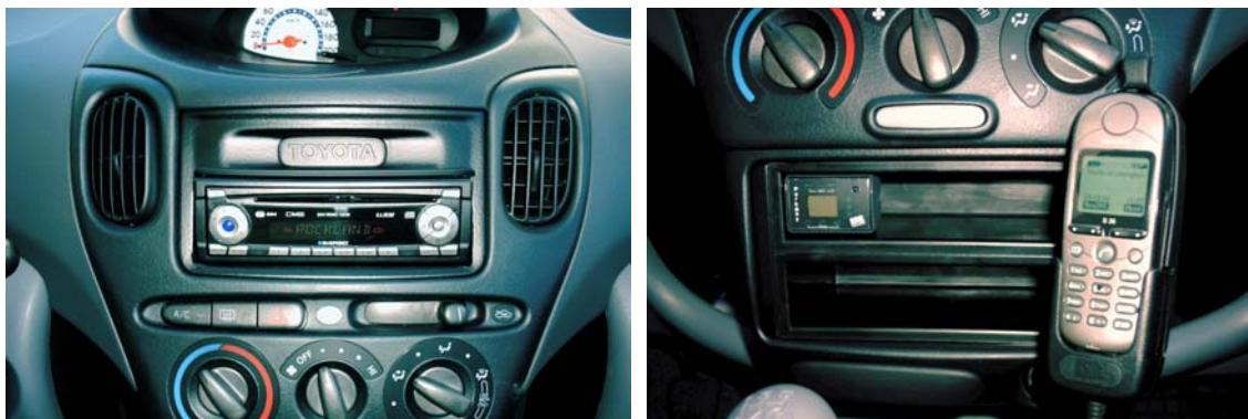
Der Einbau der THB Freisprecheinrichtung mit einer Hirschmann Planarantenne sowie der modifizierten Halterung für das angelieferte Siemens S35i stellte keine zusätzlichen Anforderungen an uns.
