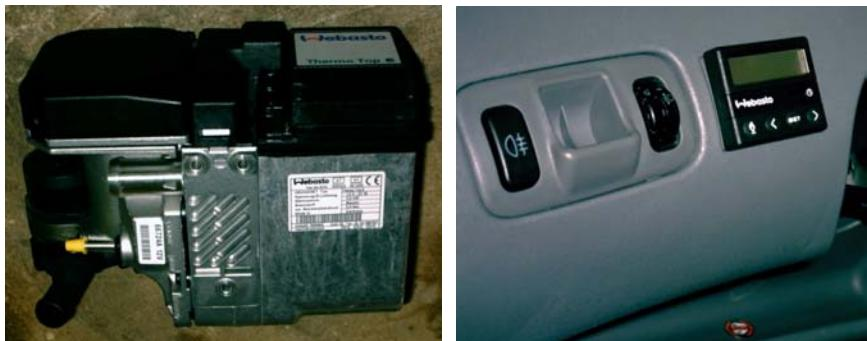
Nach dem Einbau des eigentlichen Standheizungsgerätes und dem Wasseranschluss
